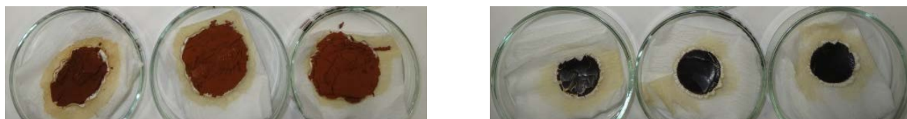
図 5 3. 固液分離により回収できた固相。左：振盪処理、右：湿式メカノケミカル処理。
