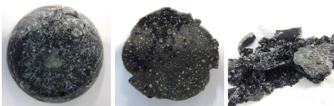
図 6.8 PCB3g、活性炭 1g 添加して溶融した試料底面（左）、上部（中央）崩れた試料（右）
