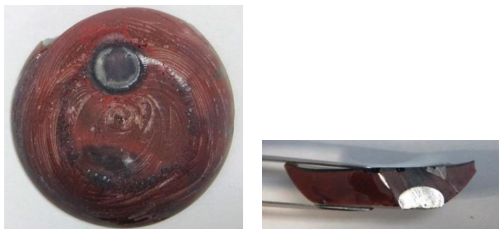
図 6.6 PCB 1g 添加、N 2 40 分通気で熔融した試料の底面（左）と断面（右）
