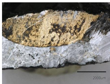
図 6.21 沈殿金属の光学顕微鏡像（×40）
