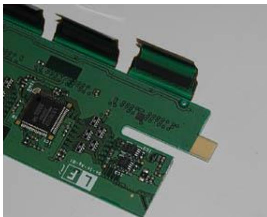
図 3.9 PCB の接続部分
