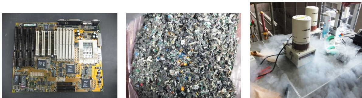
図 3.7 パソコンのプリント基板（左）、粗粉碎物（中央）、凍結粉碎の様子（右）
