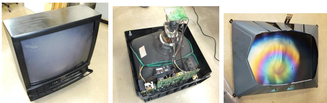
図 3.2 テレビの解体写真 左：解体前、中央：ブラウン管後部、右：シャドーマスク
