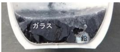
図 1 還元熔融した模擬ガラスの切断面写真
