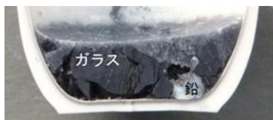
図 4.1 還元溶融した模擬ガラスの切断面写真
