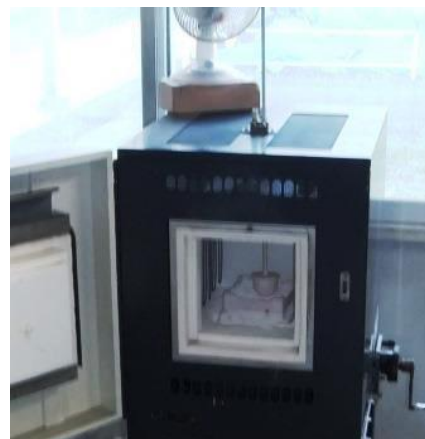
図 6.15 排気管、るつぽと電気炉の写真
