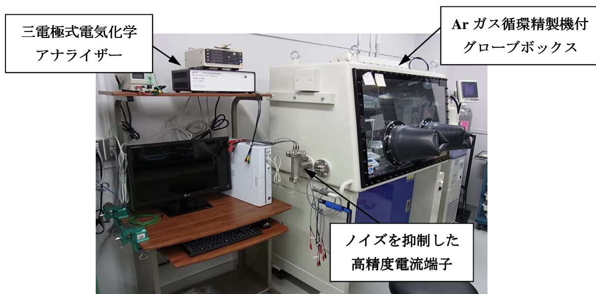
Fig.2-2-5 Nd 金属の連続回収に向けたイオン液体電析装置の外観図
