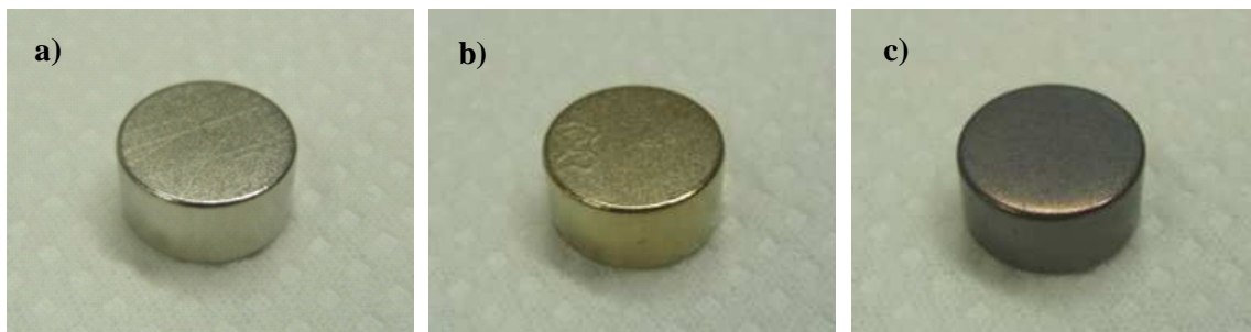
Fig.3-1-2 熱減磁処理後の Nd-Fe-B 磁石表面(a: 310°C, b: 350°C, c: 600°C)
