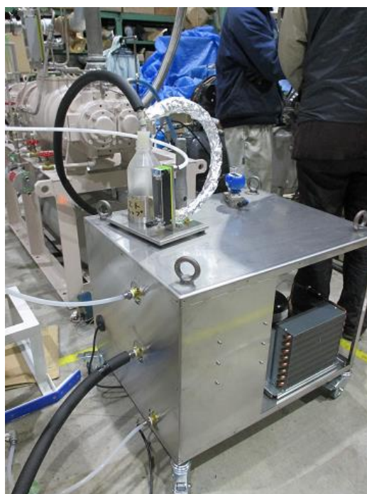
図 3-2-25 排気ガス中水蒸気の冷却凝縮装置
