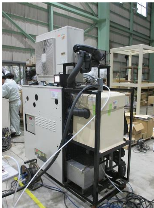
図 3-2-24 排気ガス中揮発有機塩素化合物 (VOCC) のハイブリッド型冷却管を用いた冷却凝縮装置
