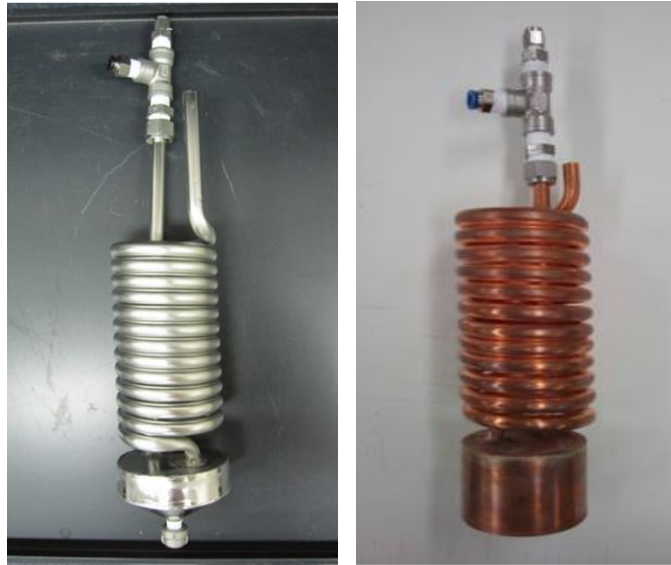
図 3-2-11 ステンレス製（左）及び銅製（右）冷却管
