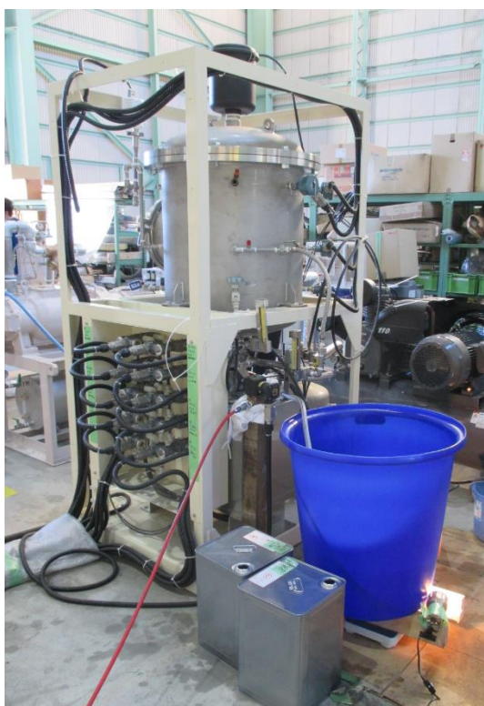
図8 廃溶剤からのVOCCの蒸発分離による廃溶剤リサイクル装置
