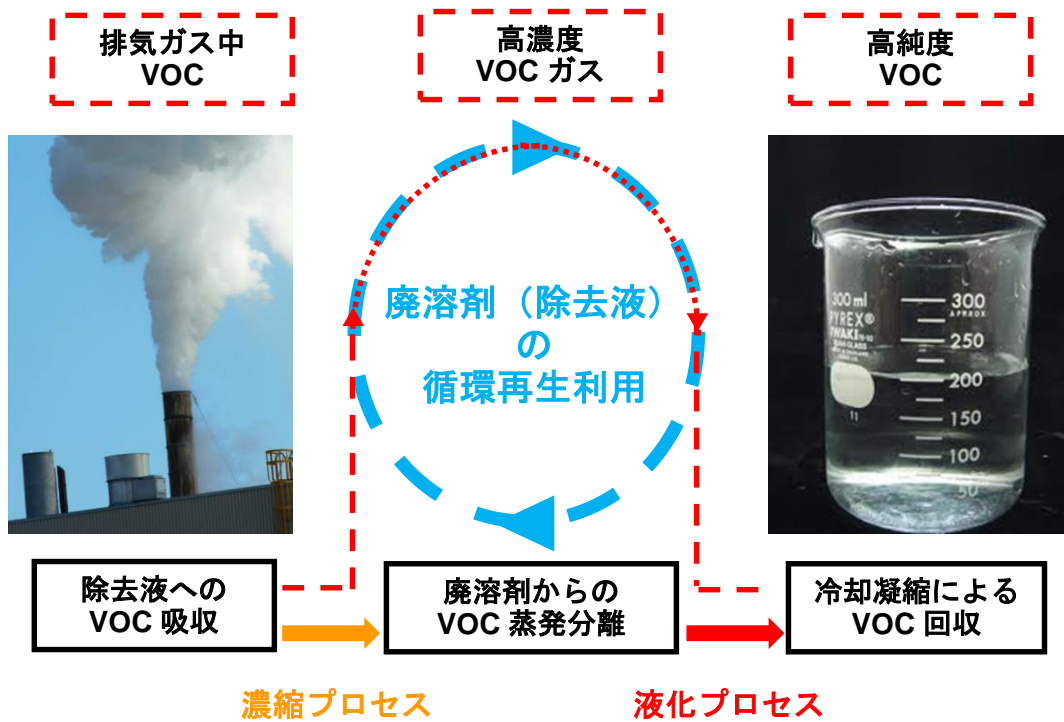
排気ガス中 VOC 除去・廃溶剤再生利用・VOC 回収
