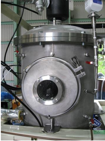
溶剤リサイクル装置 (真空容器内で溶剤噴霧)
