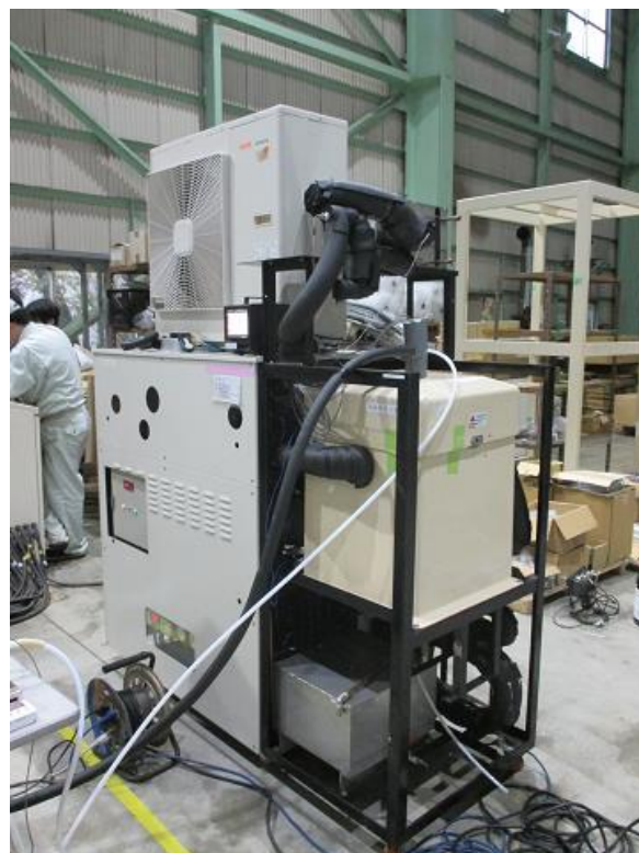
図9 排気ガス中揮発有機塩素化合物(VOCC)のハイブリッド型冷却管を用いた冷却凝縮装置
