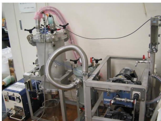
図 3-2-1 「空気流動真空蒸発法」による IPA ガスを吸収した廃溶剤再生装置
