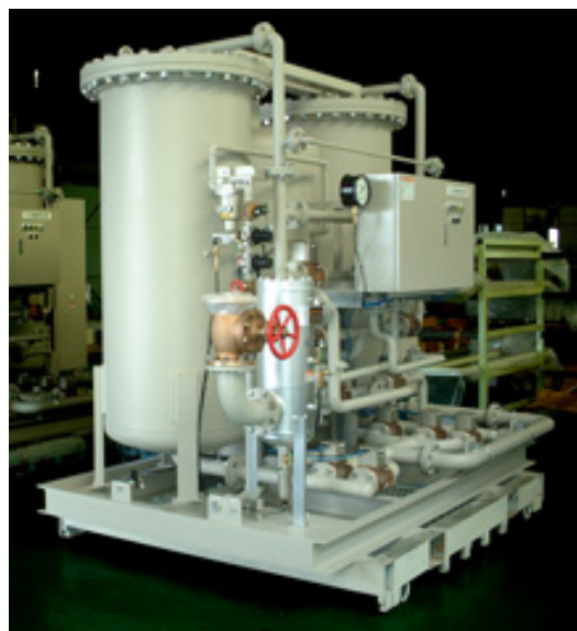
図 3.1 圧力スイング型酸素製造装置
