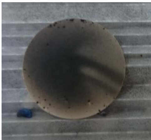
図 3.23 セルの燃料極触媒 Ni-Li(モル比 Ni:Li=3:5) (ミスト熱分解法)
