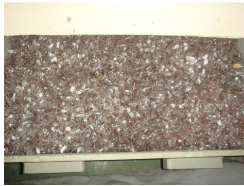
写真4 回収した口金フィラメント部
