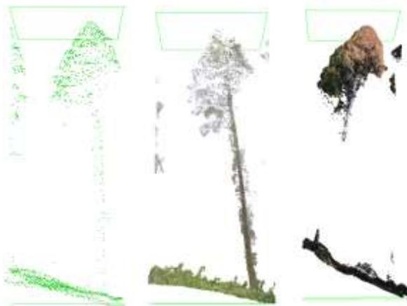
図8 単木単位でのデータ比較 (左図: 航空機レーザー、中央: 地上レーザー、右図: UAVから取得した写真画像だけからSfMにより3次元データ化した結果)。
