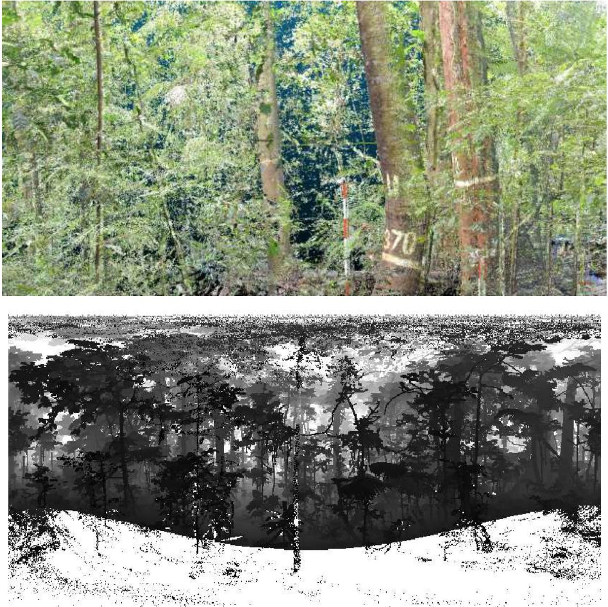
図 16 オーストラリアでの高精度 RIEGL VZ400 地上レーザーによる 3 次元データ（上図、色はカメラで撮影された色データを 3 次元データと表示している。）と、レーザーデータで取得した調査地概況のパノラマ図（下図）。
