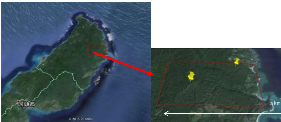
図6 沖縄にある国頭村国有林内で航空機レーザーデータが取得されている範囲と現地で地上レーザーによって取得した場所。航空機レーザーが過去に取得されていた場所は、沖縄本島北側の赤枠内（左図）、さらに国有林で調査許可が出た場所（右図、黄色ピン留めした場所）で地上レーザーと毎木調査データを取得した。
