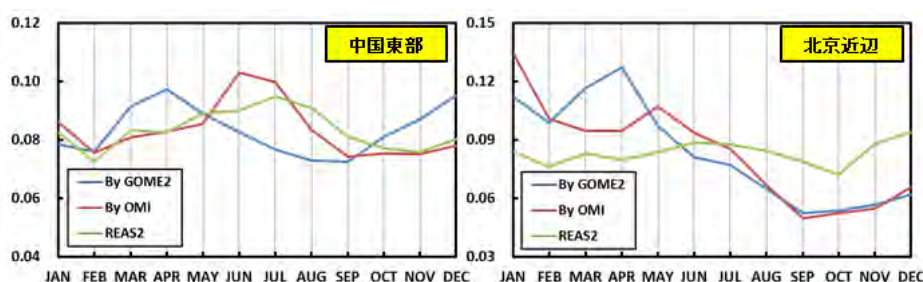
図5 中国東部と北京近辺における2008年のNO x 排出量季節変動。カルマンフィルタ法とNO 2 カラム濃度衛星観測データ(GOME2とOMI)による逆推計結果とREASv2との比較。
