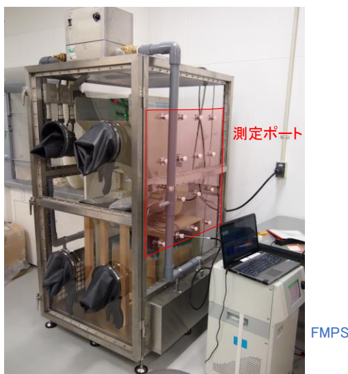
図1 大型チャンバーを用いた測定系
