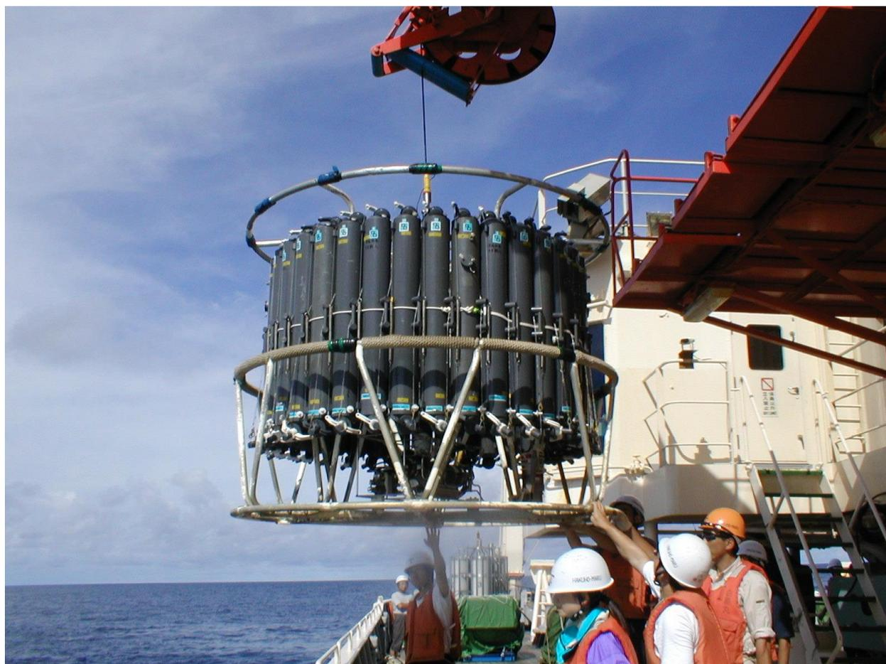
図(1)-3. 学術研究船白鳳丸上で使用中のCTD採水システム（12L-ニスキンX採水器36本搭載）
