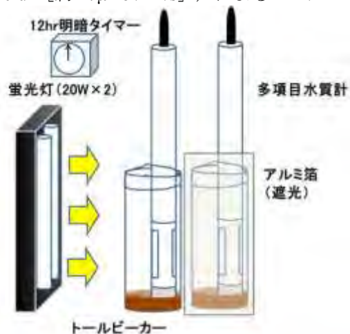
図(3)-2 本研究で開発した底質中の藻類シードの光合成活性評価システム
