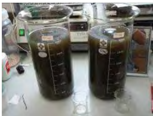
図(3)-1 底質を投入して攪拌直後の様子
