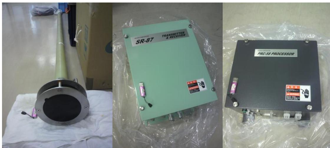
図(1)-3 小型計量魚群探知機KCE-300(120kHz, 株式会社ソニック社)。左から、T-182B型送受波器(8kg)、SR-87型送受信器(25kg)、PRC-58型演算器(5.4kg)。
