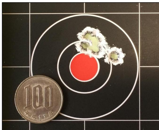
図(2)-1 Varmint Grenade装弾により100mの距離で14.5mmの集弾性能が確認された標的（撃ち込み数は5発）
