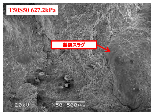
図-3.2.22 T50S50 の SEM 画像 (左 : 圧密応力 78.4kPa、圧密応力 627.2kPa)
