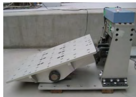
図-2.5.3(b) 模型の傾斜台
