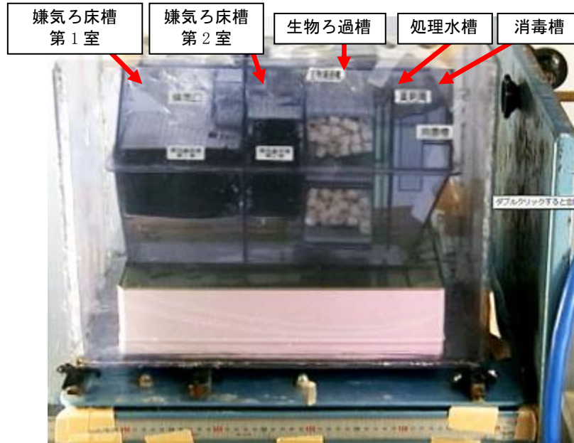
図 3-1-7 浄化槽のミニモデル(嫌気ろ床生物ろ過方式)による振幅実験の様子
