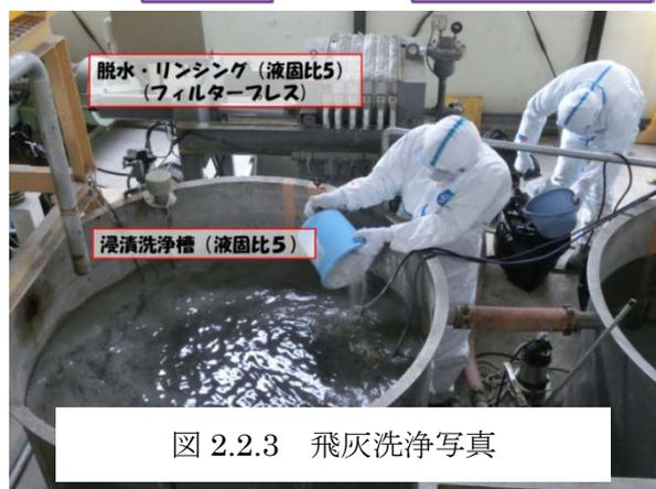
図 2.2.3 飛灰洗浄写真
