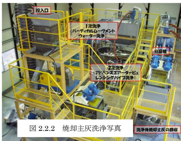
図 2.2.2 焼却主灰洗浄写真
