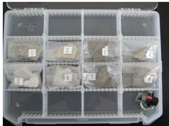
図 3.1.1 石綿含有建材判定テスト試料
