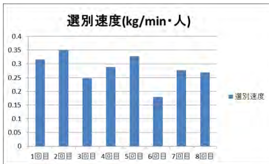
図 4.2.7 ①がれき類主体の混合廃棄物からの選別速度
