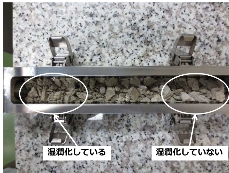
図 5.1.9 湿潤化後の供試試料の状態
