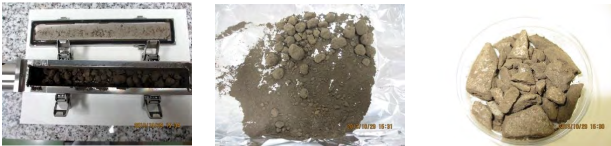
図 5.1.5 実験後の供試試料(左：タンブラー内部、中：土壌、右：アスベスト含有建材)
