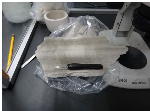
図 5.1.2 実験に使用したアスベスト含有建材(左：コロニアル屋根材、右：波形スレート板)
