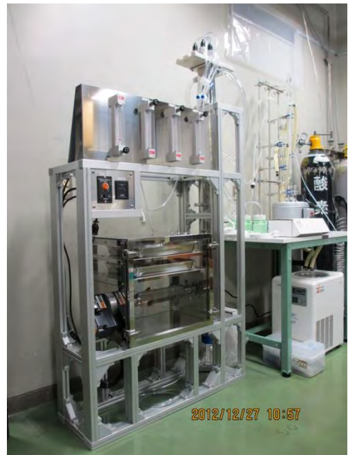
図 5.1.1 ダスト発生装置の模式図(左)及び実機写真(右)
