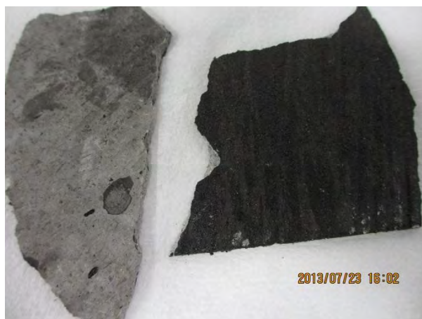
図 5.1.2 実験に使用したアスベスト含有建材(左：コロニアル屋根材、右：波形スレート板)
