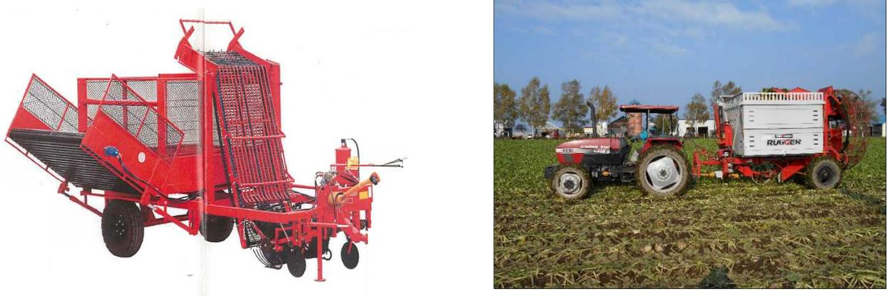
図1.4 ビートトップ回収機械（左：過去に販売されていた機械、右：試作機）
