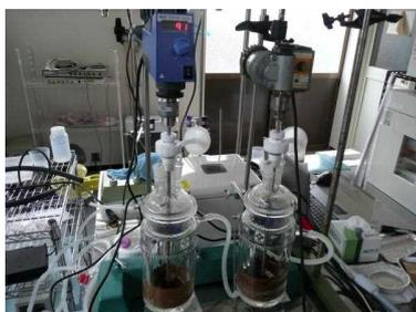
図2 攪拌反応装置
