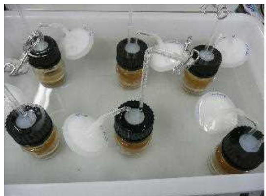
図 4.13 小型糖化発酵試験装置
