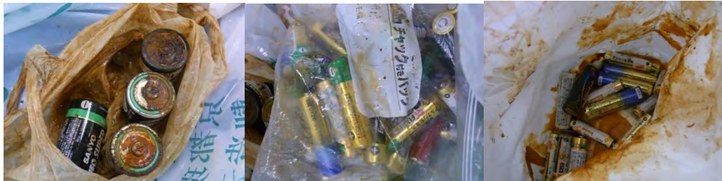
図 3.4-16 液漏れを起こしていた電池
