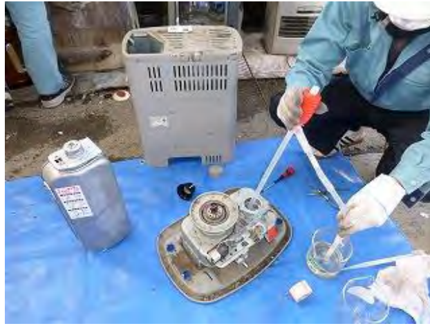
図 5.3.25 ストープの残存灯油の調査状況（左：外付けタンク、中央：内蔵タンク）
