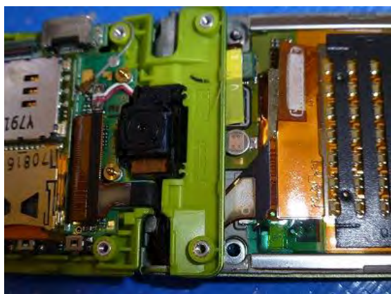
図 5.3.20 携帯電話の内蔵電池の例 (メモリーバックアップ用リチウム電池)
