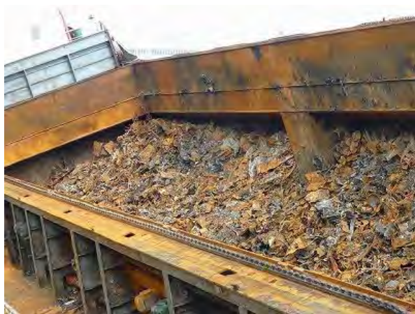
(1) 燃えたスクラップと消火作業によって傾いた船倉
