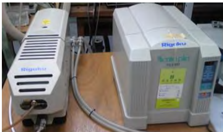
図 4.5.17 熱分析装置(リガク Thermoplus TG 8120)
