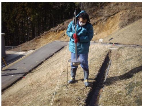
写真 4.1 落球探査状況
