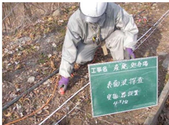
④ 受振器設置 (4.5 Hz 型)
