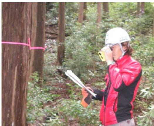
写真1 ノンプリズム測距計の例（片手で操作可能なもの）
