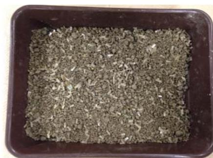
図 6.4 作成したプラスチック片混合土
