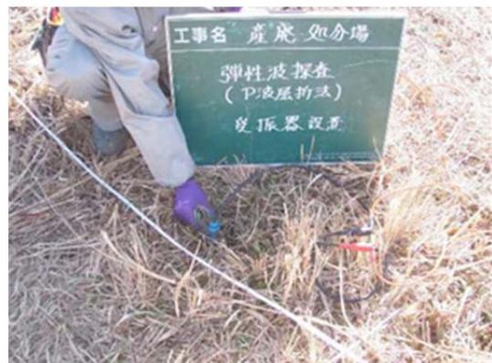
② 屈折法弾性波探査の測定機器一式
