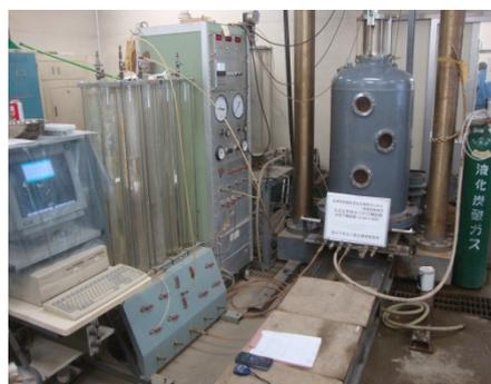
写真 6.2 大型三軸圧縮試験装置
