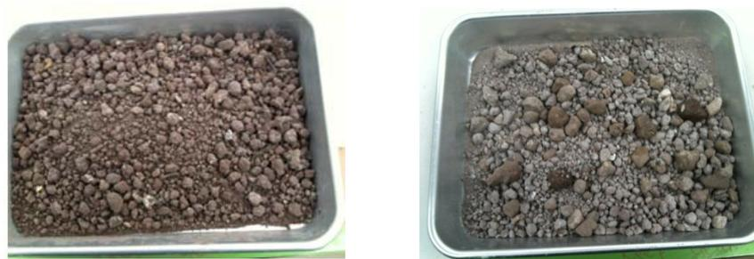
図 6.2 使用した廃棄物試料の外観（左：9.5 mm ふり通過分、右：19.5 mm ふり通過分）
