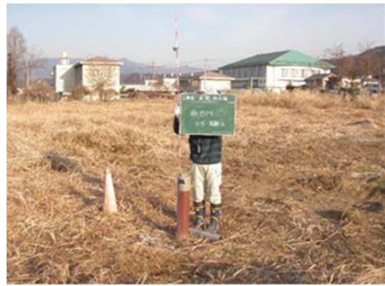
① 水準測量基準点：4 九 H11-117 (EL = 253.100 m) および T5 孔の管蓋面 (EL = 254.215)
