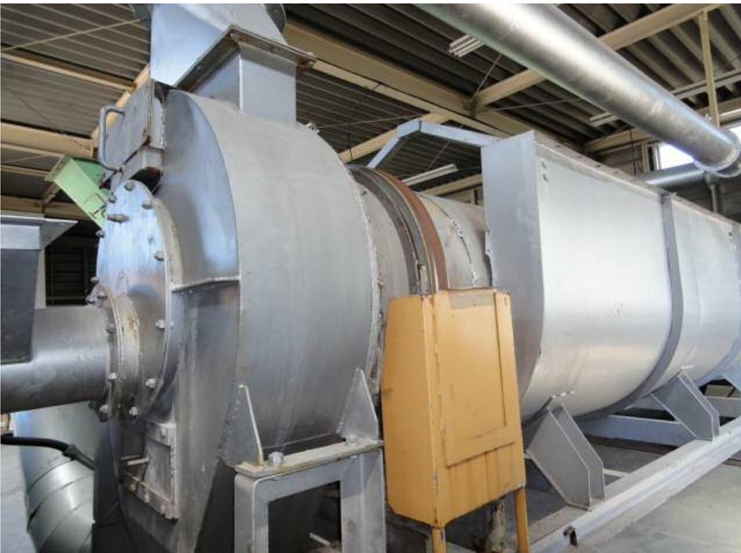
写真. 2-8 灯油バーナ乾燥装置（乾燥機）
