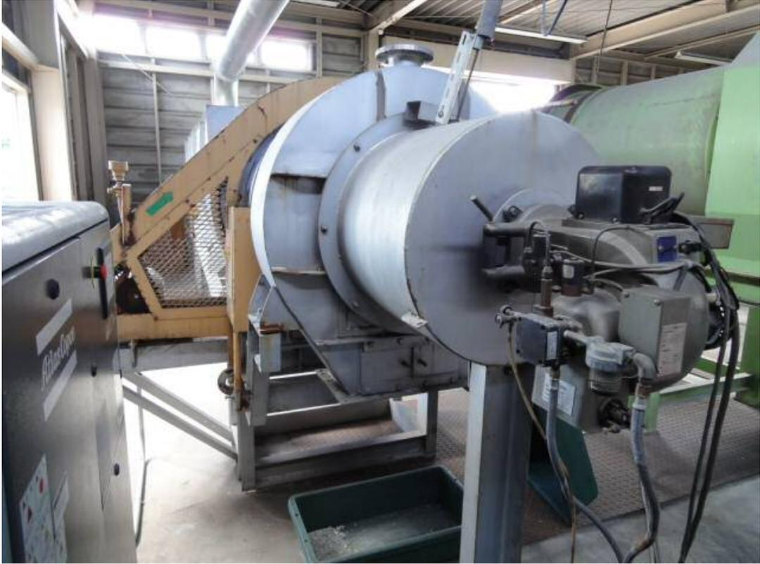
写真. 2-7 灯油バーナ乾燥装置（バーナ部）
