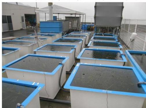
図(2)-3 大型水槽を用いた藻場マイクロコズム実験
