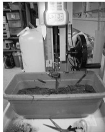
図(2)-11 引き抜き試験の様子
