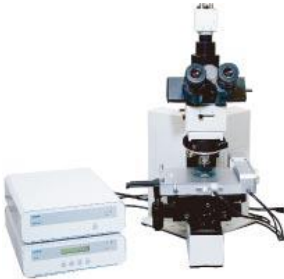
顕微鏡用冷却加熱せん断ステージ設置例
