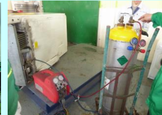
K社でのJICAによるフロン回収実験
