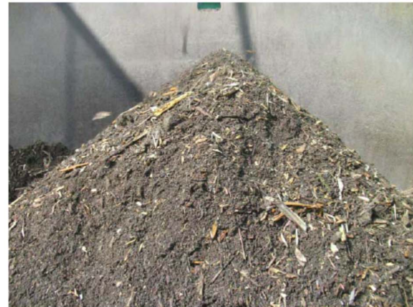
木くずが残った分別土砂・篩下残渣 (復興資材として利用?)
