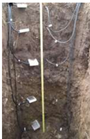
地中熱・水循環観測
