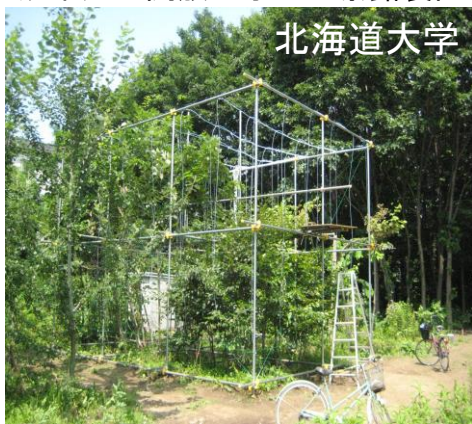
成木用の開放型オゾン暴露装置
