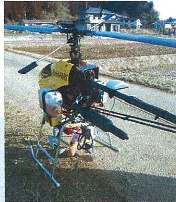
機材前影(左)・後影(右) UAV下にDSM取得用デジタルカメラと放射線測定器を搭載
