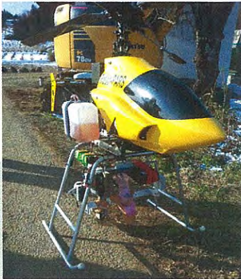
機材前影(左)・後影(右) UAV下にDSM取得用デジタルカメラと放射線測定器を搭載
