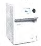
SMPS ナノ粒子の粒径分布計測
