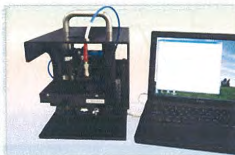
図 リースで慶應義塾大学に導入した有機薄膜太陽電池構造の光学解析システム テクノシナジー社製光学膜厚測定システム (DF-1030R)
