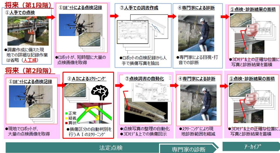
図 6 ドローンや AI 技術を用いた効率的な点検 出所) 国土交通省
