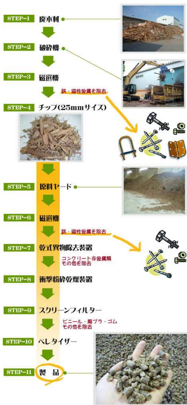
図 3-63 木質燃料ペレット生産フロー 出所) (株) バイオマス再資源化センター
