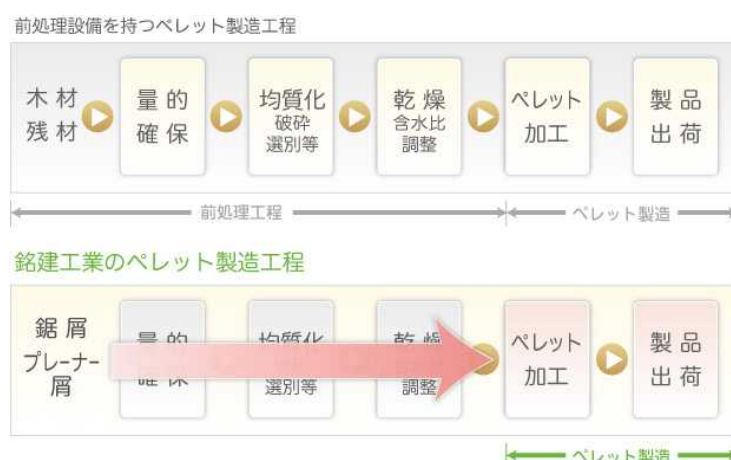
図 3-56 銘建工業のペレット生産プロセス 出所) 銘建工業（株）
