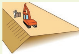
2. 除染（路面の表土剥ぎ）
