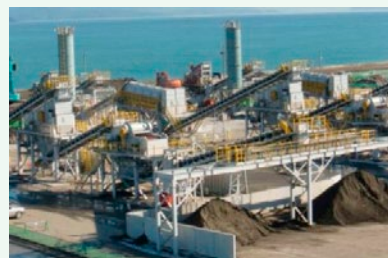
写真2-1-2 津波堆積物処理装置（破碎・選別施設の一つ）
