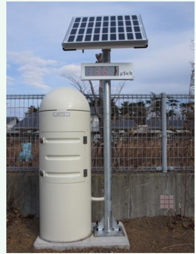
写真2-2-4 リアルタイム線量測定システム
