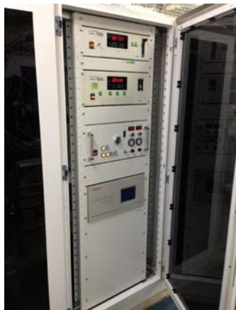
試験用ガス調整装置（加湿・流量制御）
