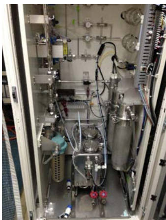
試験用ガス調整装置（加湿・流量制御）
