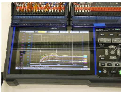
図17 フレキシブル面状ヒーターの測定状況
