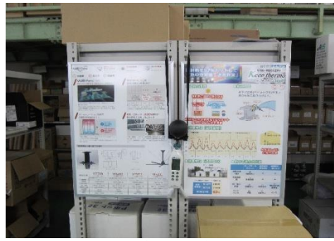
倉庫 A 内にグローブ温度計を設置
