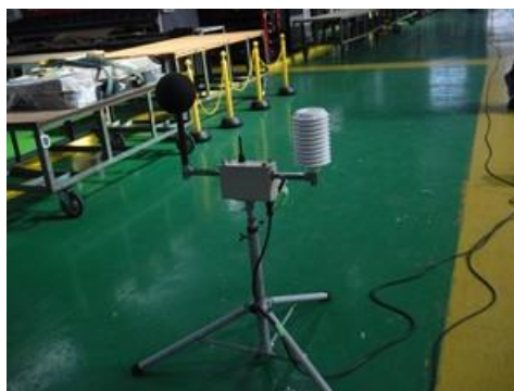
WBGT 計（温湿度、黒球温度の測定）
