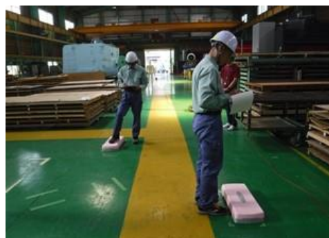
WBGT 計（温湿度、黒球温度の測定）
