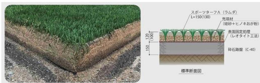
図 実証対象製品の外観と断面構造
