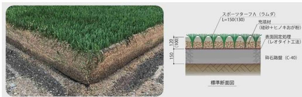
図3-1 実証対象製品の外観と断面図
