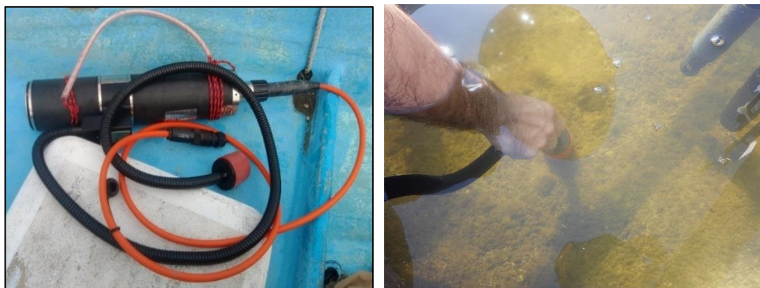
図 5.3-7 左図：計測機器（ベントフロー） 右図：計測状況
