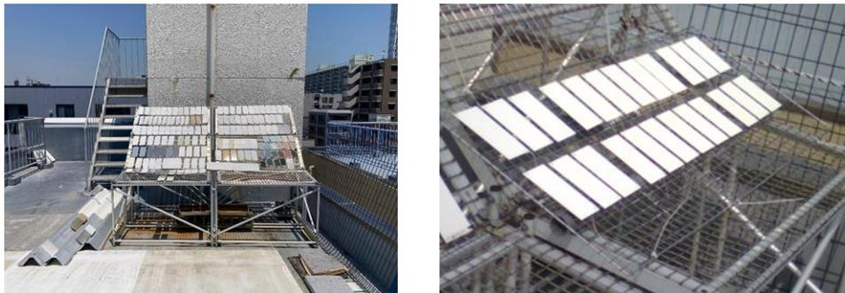
図-8 都市部 屋外耐候性曝露試験台設置状況
