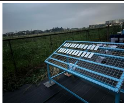
全体概要-図4 本所サイト・久喜サイト屋外耐候性曝露試験台設置状況
