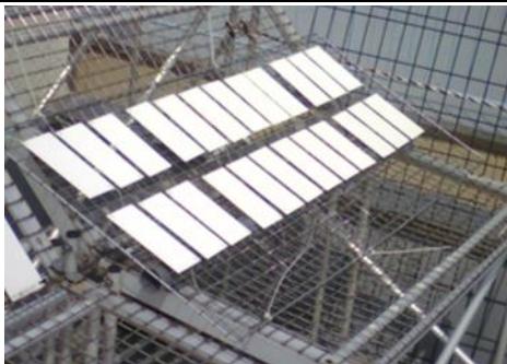
全体概要-図4 本所サイト・久喜サイト屋外耐候性曝露試験台設置状況
