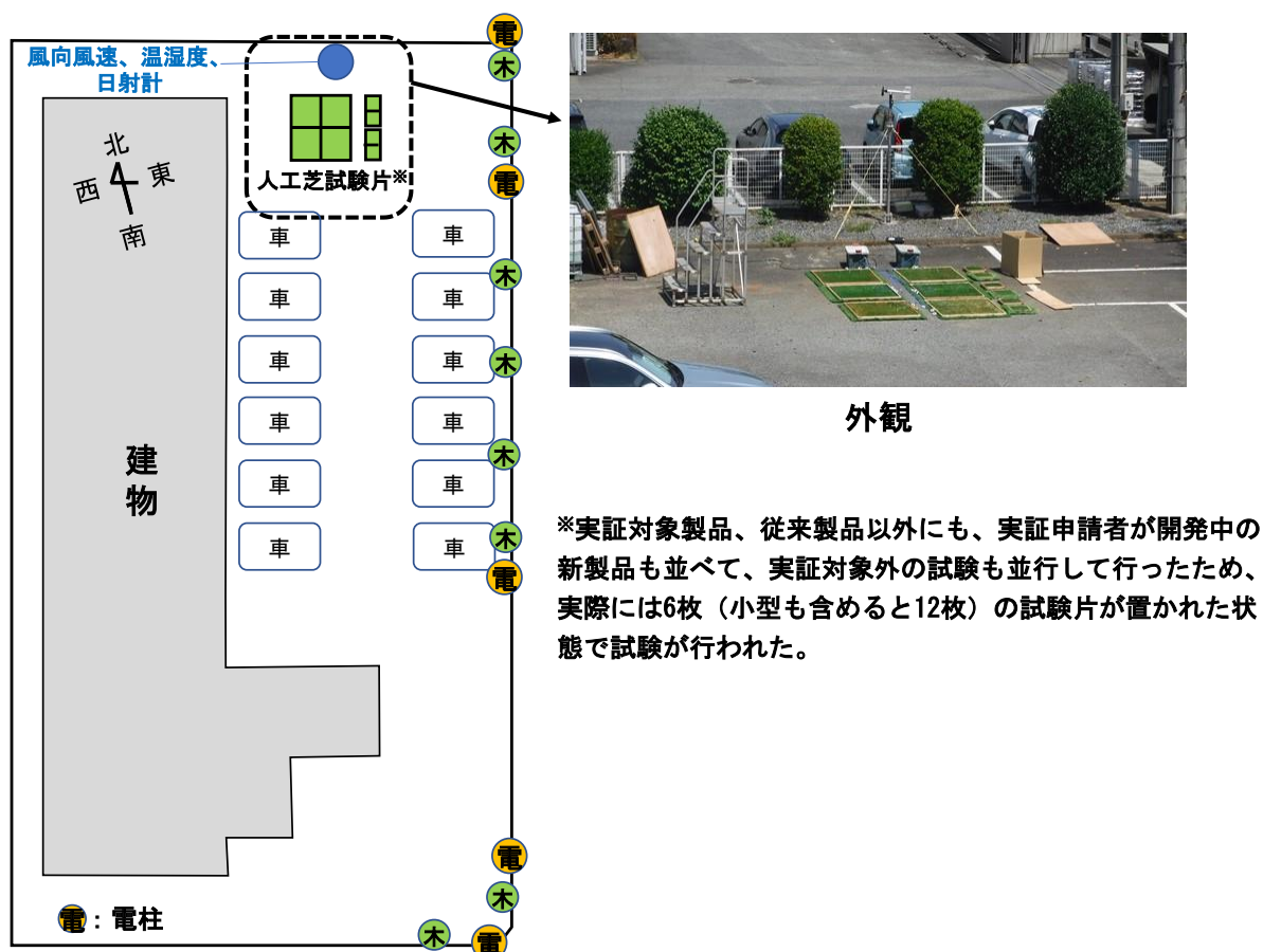
図5-3 試験実施場所における試験片等の配置（温度上昇抑制効果等に関する試験）
