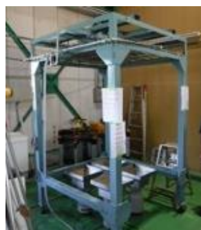
雨量計による散水量確認
