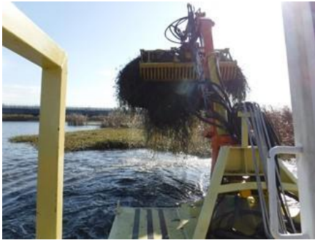
図6-10 実証対象製品による水草の除去（引き上げ）の様子
