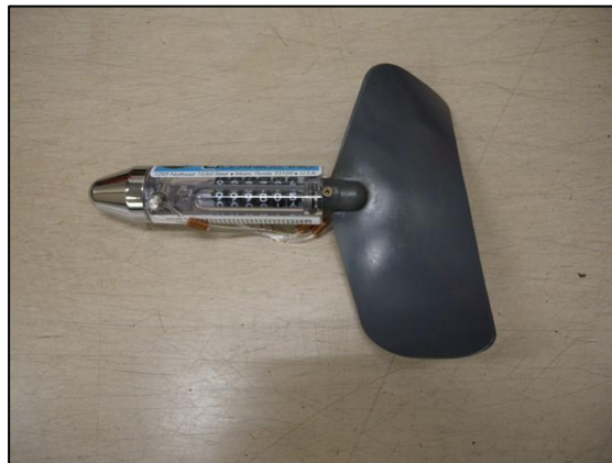
図4-3 プランクトンネット（写真左）と ろ水計及び低流速用ローター（写真右）
