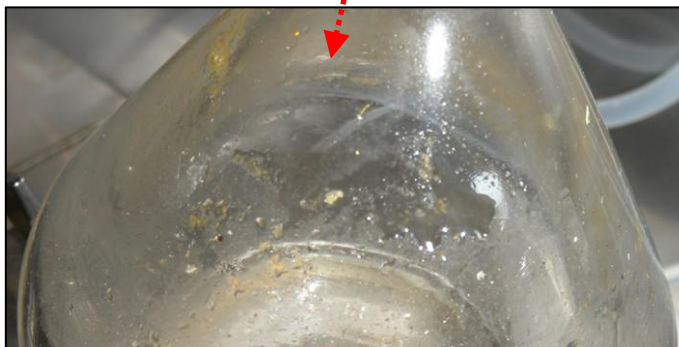
ガラス壁面に付着した残渣の様子
