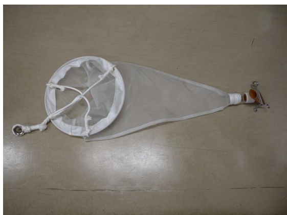
図4-3 プランクトンネット（写真左）と ろ水計及び低流速用ローター（写真右）
