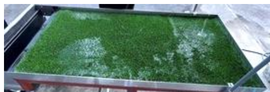
従来工法 （降雨量 30mm/h、散水開始から 10 分後）
