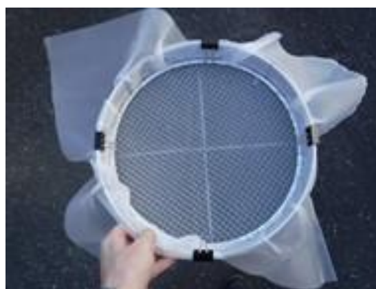
図5-4 プラスチック片の回収に使用したネットの外観
