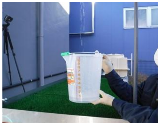
降雨量確認の様子
