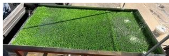
従来工法 (降雨量 150mm/h、散水開始から 10 分後)
