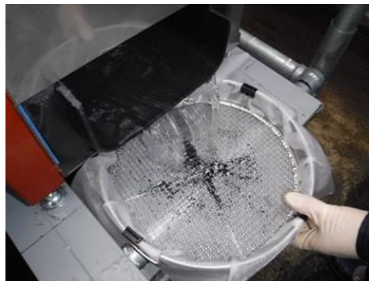
プラスチック片等の回収の様子（従来工法）
