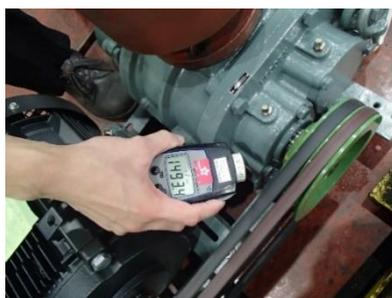
図 11 軸回転速度計
