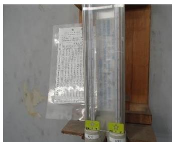
図 15 測定雰囲気乾球・湿球温度計
