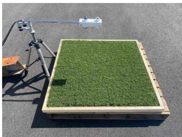
図5-3 日射反射率の屋外試験方法の概要
