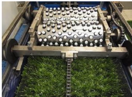
図5-12 摩耗試験機（出典は上記 JFA ガイドライン）
