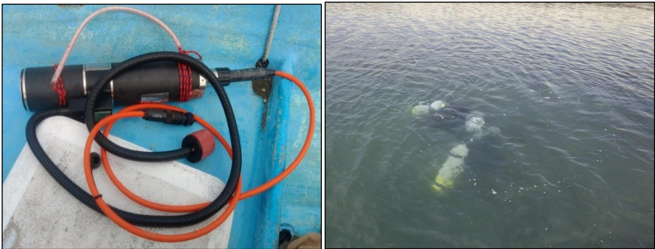
図 4-5 左図：ベントフローの外観 右図：ベントフロー調査状況
